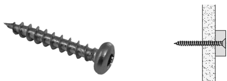
Direkte oppheng med 5 mm skrue i Habito-plate.
